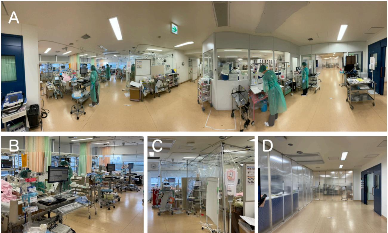
HCU コロナ病棟（第2ICU）の写真。Aは病棟全体のパノラマ写真、Bはオープン床、Cはビニル製の陰圧テント床、Dはビニルパーテーションによる臨時の第二期工事の写真。
